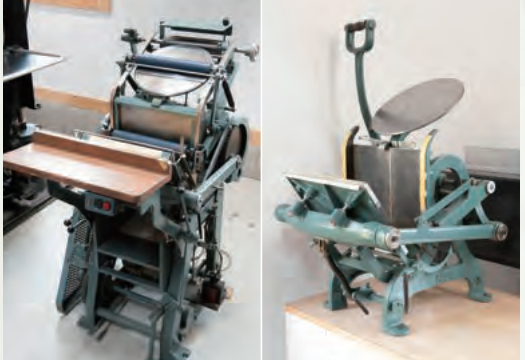
(左)自動で動くローラーに、手差しで紙を入れる半自動印刷機。(右)すべてを手動で行う小型印刷機。大きさは違っても、そのしくみは同じだとか。
