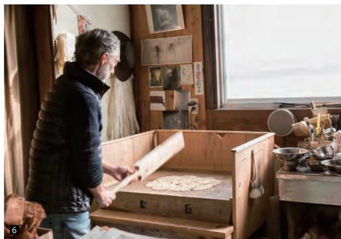
⑤和紙の品質を決める“ちりとり”と呼ばれる工程。紙料に付着している黒皮などのチリ、変色してしまった部分などを冷たい流水の中で丹念に取り除く。⑥木製の棒で叩き、繊維をほぐす叩解(こうかい)と呼ばれる工程。道具もロギールさんの手づくり。⑦繊維に水とトロアオイの樹液を加えて混ぜ、紙を漉く。⑧漉いた和紙は天日に干し、乾燥させたら完成。
