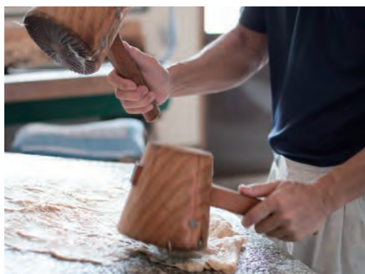
ちりとりを終えた原料を、紙打石(かみうちいし)という石の板の上に広げ、自作した叩き槌で叩く。
