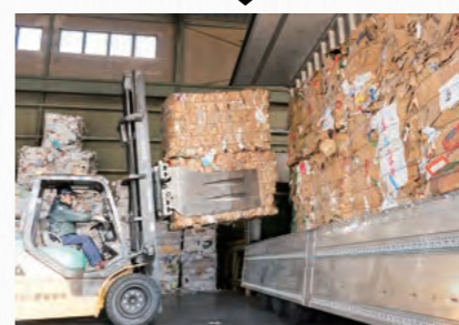
回収した古紙から、ビニールひもなどの不要物を手作業で取り除いたのち、ペーラーと呼ばれる機械に投入。約1トンの塊に圧縮したのち、番線(針金)をかけて結束し、製紙会社へ出荷する。
