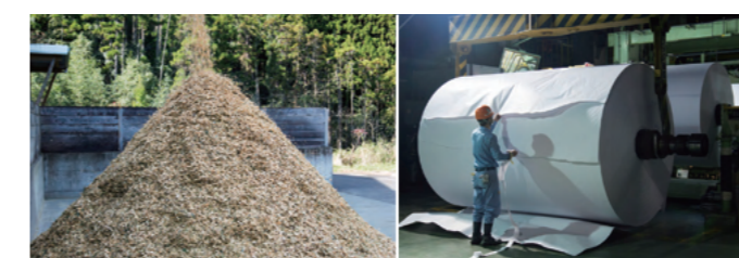
伐採された竹は集荷されてチップ工場へ。チップングした竹チップはバッチ釜と呼ばれる蒸解釜でパルプ化されたのち、抄紙工程を経て「竹紙」が完成する。
