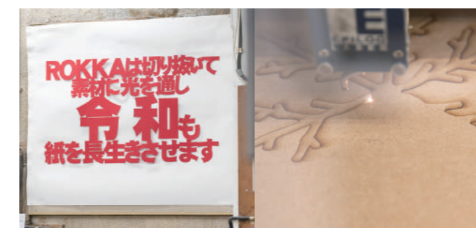
(左)創業10周年を迎えた2019年に、馬場社長が掲げた同社のコンセプト。(右)同社のレーザーカット加工は、紙だけでなく、木材、アクリルなどの素材にも対応できる。
