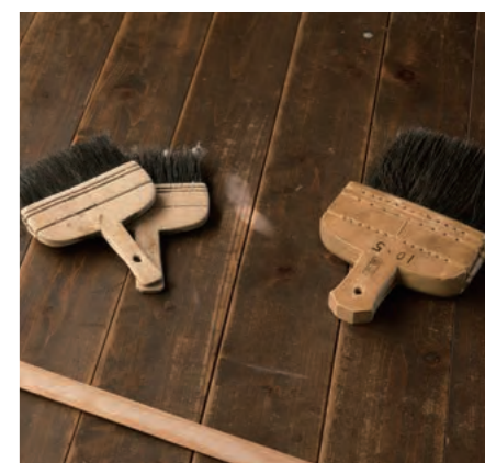
上下の和紙の繊維を絡ませるための「打ち刷毛」(右)と、和紙に生麩糊を塗るための撫で刷毛(左)。
