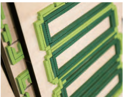
箱の形状に打ち抜くための刃物を埋め込んだ「木型」
