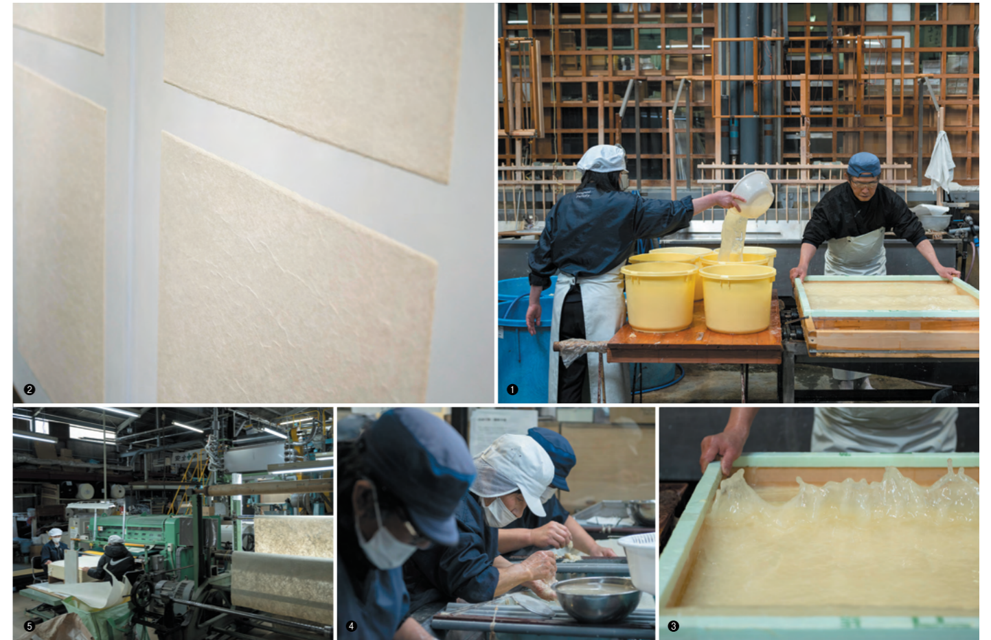
①②厚みのある和紙づくりに適した「溜め漉き」を行う様子。③脱水用具で水分を吸い取った紙を一枚ずつ干し板に張りつけ乾燥させる。④和紙繊維を水中のかごに入れ、傷、芽、吹きむら、変色した部分を除去する「ちり取り作業」の様子。⑤伝統的な「流し漉き」の手法はそのままに大量生産を可能にする「機械漉き」も行っている。
