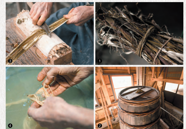
①収穫したばかりの楮。②束ねた楮などの原料を蒸す甑(こしき)。③表皮を剥ぎ取る様子。④冬の冷たい水に手を入れ、不純物の一つ一つ手作業で取り除いていく。
